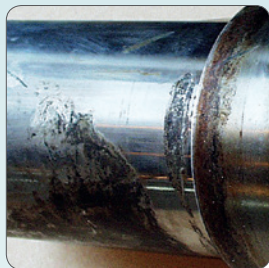
Corrosione (Albero)
