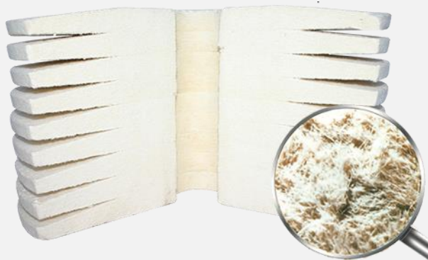
Sezione trasversale – cartuccia del filtro di profondità usata
